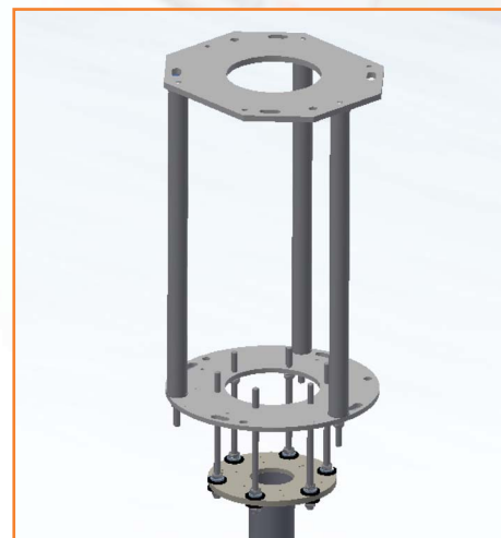
Unterkonstruktion mit Montageplatte und Verlängerung zur Überbrückung großer Zwischenräume
