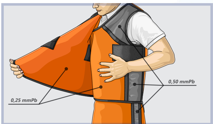
Abb. 6: Farblich abgesetzte Sicherheitszonen für ein sicheres Schließen von Weste und Rock. In diesem Beispiel hat das Kostüm einen Bleigleichwert von 0,50 mmPb.
